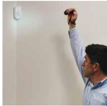
**Test de marche rapide** : déclenche le mode de test de marche avec une lampe de poche et réduit le nombre de déclenchements du capteur lors de l'installation.
