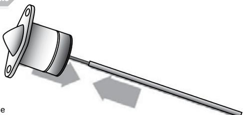
Faire glisser l'antenne dans le guide d'antenne (paille) fourni.
