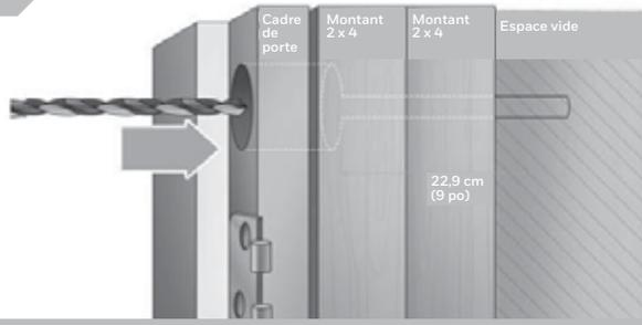
Percer un trou de 0,65 cm (1/4 po) au centre de la cavité à travers le jambage, de sorte que l'antenne puisse être insérée à travers le jambage et les montants.
