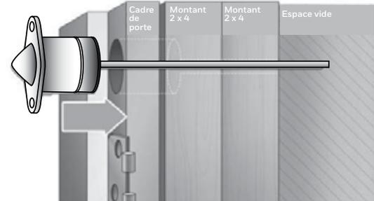
Insérer le contact et l'antenne dans le jambage.
