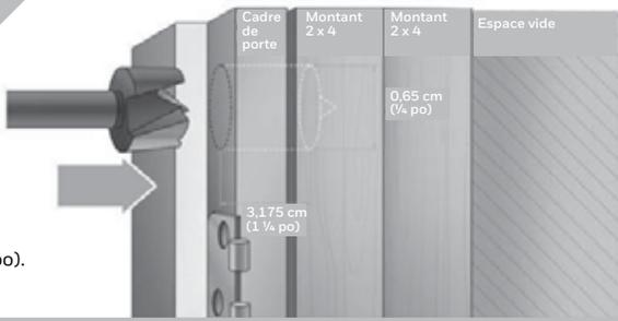
Utiliser un foret de 0,65 cm (1/4 po) pour percer le montant de la porte à une profondeur de 3,175 cm (1 1/4 po).
