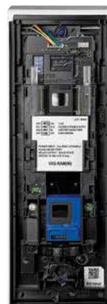
Vue ouverte PBC sur le circuit imprimé
